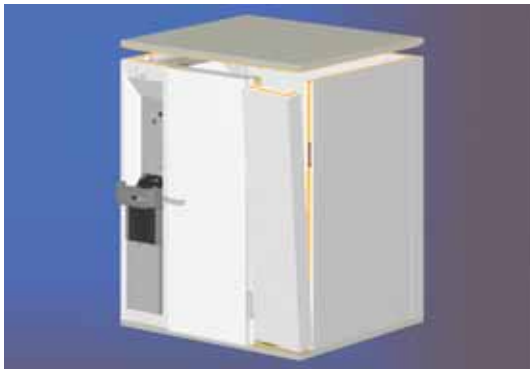
zdj. 8 montaż elementów narożnych i dachu
