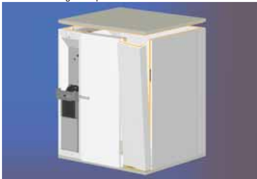
Photo 8. Montage du plafond et des angles
