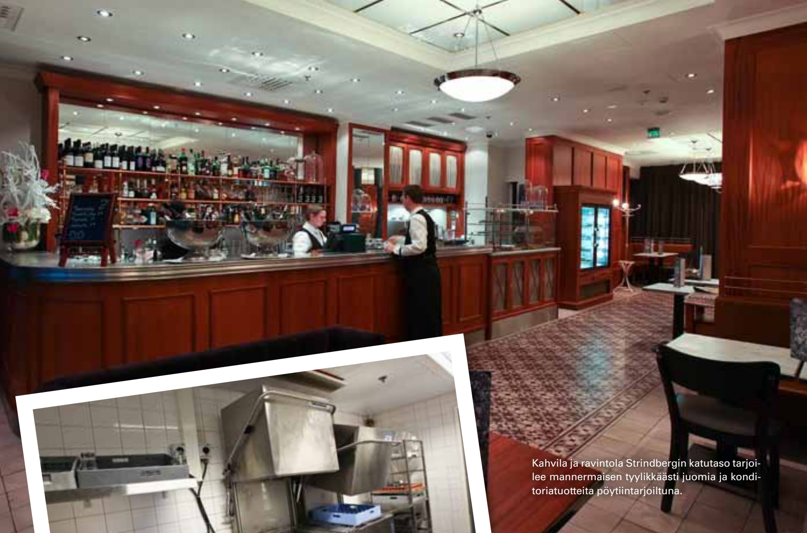
Yläkerran keittiön pesuosastolla on käytössä uusi esipesukone Metos WD-6 PRM. Kupujen nosto ja lasku tapahtuu automaattisesti. Pumpullinen esipesu puhdistaa astiat tehokkaammin kuin käsisuihku. Kapasiteetti lisääntyy, kun käytännössä kaksi koria on koneissa samanaikaisesti. Pesukustannukset ja ympäristörasite pienenevät, kun loppuhuuhteluvesi voidaan hyödyntää esipesussa.
