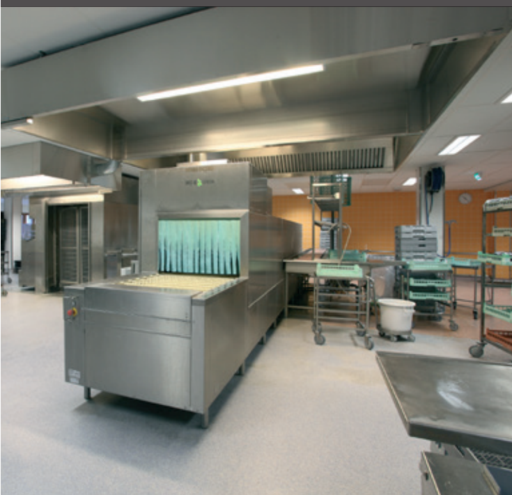
Taustalla näkyvässä Metos WD-18 vaununpesukoneessa pestään potilastarjotinvaunut. Etualalla Metos WD-B tappimattokone.
