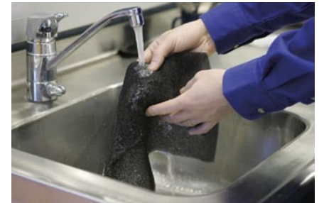
Irrotettavan suodattimen voi pestä ja huuhdella vesihanalla.
