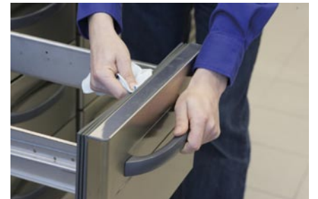
Puhdista ja tarkista tiivisteet. Katso samalla, että laatikot ja ovet sulkeutuvat tiiviisti.
