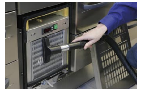
Harjaa ja imuroi lauhduttimen lamellien välit puhtaaksi.
